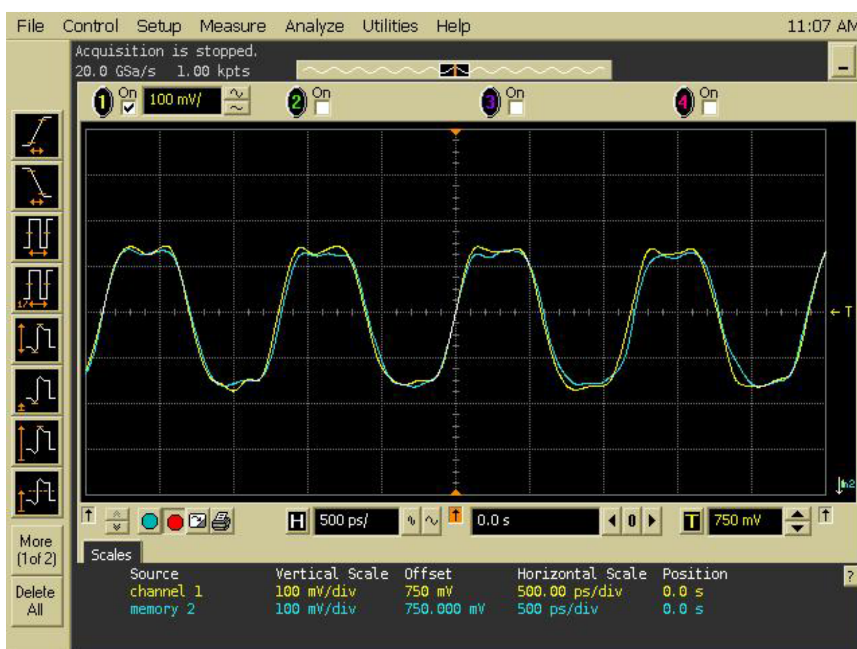
図2-1：ソケットの違いによる 波形の比較 (共にピン端で測定)
