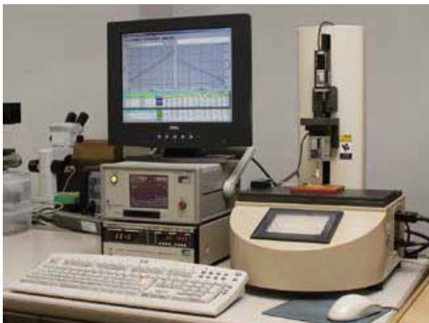
接触抵抗・荷重測定器 (弊社オリジナル) FDR Measurement Equipment
