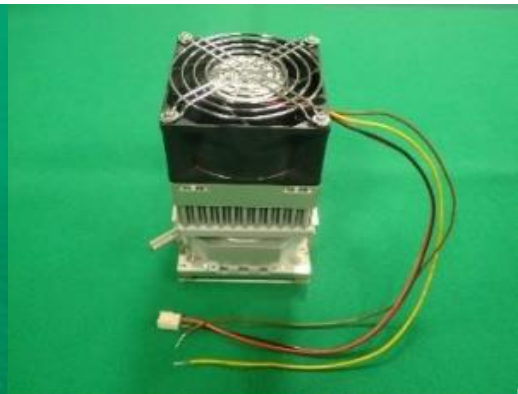
放熱機構を組込んだ一例 (キャップ+ヒートシンク+ファン)
